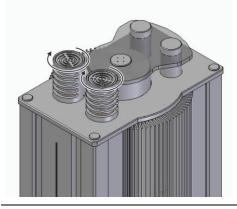
Schrauben Sie die Röhrenabdeckung im Urzeigersinn fest.
