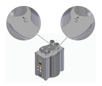
Erdungsschrauben mit Hilfe des beiligenden Inbusschlüssels entfernen.
