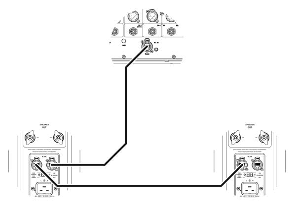
**HLINK-**Verbindung mit optionalem HLINK Verteiler /
