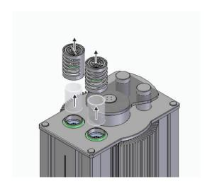
Die Röhrenabdeckungen durch Drehen gegen den Uhrzeigersinn lösen und anschließend nach oben abnehmen.
