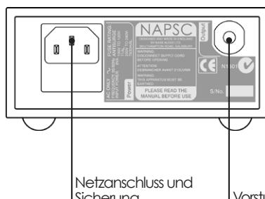
Netzanschluss und Sicherung
