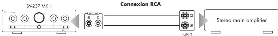
A la place de l'amplificateur de puissance stéréo représenté ici, on peut aussi bien utiliser deux amplificateurs de puissance mono.
