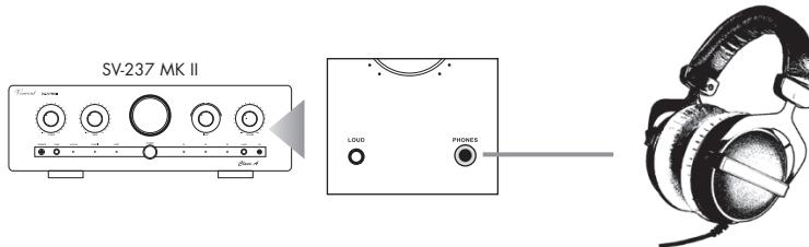
Dadurch werden die Lautsprecher abgeschaltet. Es können alle Kopfhörer mit einer Impedanz zwischen 32 Ohm und 600 Ohm verwendet werden. Ungeeignete Kopfhörer mit zu niedriger Impedanz können den Verstärker beschädigen oder unerwartet eine so hohe Lautstärke produzieren, dass Ihr Gehör geschädigt werden kann. Vor dem Einsticken sollte vorsichtshalber die Lautstärke am Drehknopf bzw. an den Tasten „VOLUME“ (5)(25) reduziert werden.
