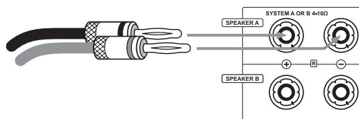
Si on utilise des câbles avec cosses, il faudra desserrer la molette de fixation en la tournant dans le sens antihoraire, insérer la cosse sous la molette et resserrer celle-ci en la tournant dans le sens horaire. Pour éviter tout dommage, assurez-vous que le branchement est bien serré et qu'aucune partie métallique dénudée de la cosse ne soit en contact avec la paroi arrière ou une autre borne de raccordement.
