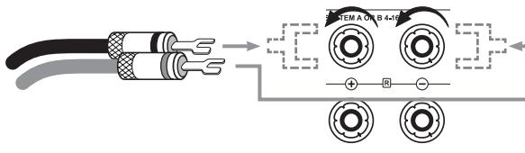
En l'absence de cosse, retirez l'isolant de chaque extrémité du câble sur une longueur d'un cm environ. Torsadez le câble dénudé, pour éviter les court-circuits, desserrez la molette de fixation en la tournant dans le sens antihoraire et insérez l'extrémité du câble dans le perçage dégagé du bornier. Serrez maintenant le câble en faisant tourner la molette de serrage dans le sens horaire. Contrôlez le serrage correct du câble.
