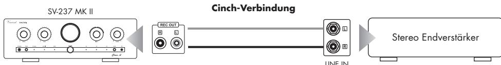
Anstelle des hier gezeigten Stereo-Endverstärkers können ebenso zwei Mono-Endverstärker oder ein Aktivsubwoofer eingesetzt werden.
