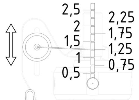
Setzen Sie das Anti-skating-Gewicht mit dem Deckel entsprechend dem oberen linken Bild in das Gehäuse ein. Führen Sie anschliessend die Schlaufe des Fadens über den Anti-Skating-Ausleger.
