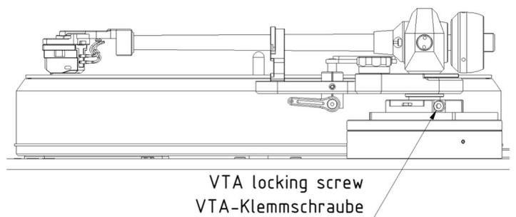
Stellen Sie die Tonarmhöhe bei eingebautem Tonabnehmer so ein, dass das Tonarmrohr parallel zum Teller oder vorne minimal tiefer ist.
