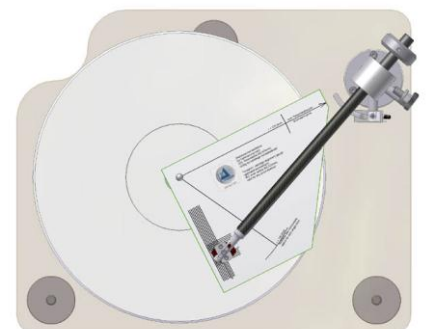
Abb.9: Absenken des Tonabnehmers auf der Schablone
