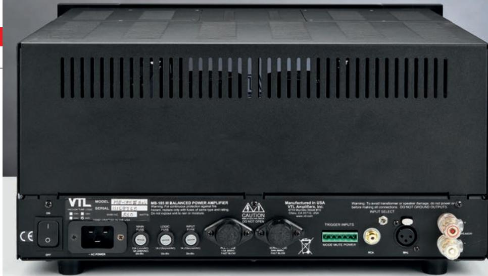
Sul pannello posteriore troviamo la presa IEC per l'alimentazione, per la prima volta per VTL in versione da 20 A, accompagnata dall'interruttore principale, l'alloggiamento per i vari fusibili di protezione, gli ingressi bilanciati e RCA, selezionabili con apposito interruttore, i morsetti di uscita e l'ingresso per un trigger che permette di asservire l'accensione a un altro dispositivo, come un preamplificatore della stessa ditta o un sistema di automazione domestica.
